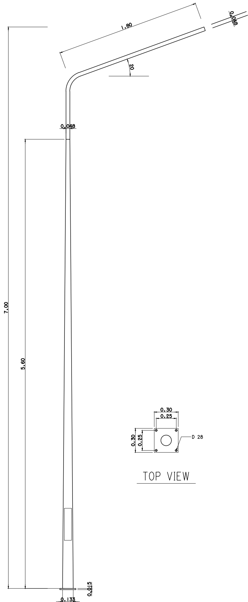
เสาไฟถนนเสาปลายเรียวกึ่งเดี่ยว HDG สูง 7 เมตร
